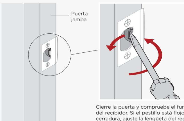
Cierre la puerta y compruebe el funcionamiento del receptor. Si el pestillo está flojo en la cerradura, ajuste la lengüeta del receptor para que sujete mejor el pestillo cuando la puerta esté cerrada.
