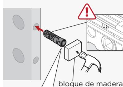
Nota: para un orificio de 38 mm de diámetro, compruebe si el pestillo se extiende y se retrae. Cincelar el área si es necesario.
